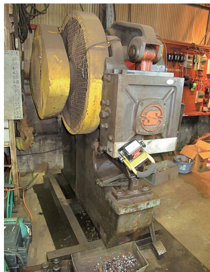
JEV二本木工作部の1972年製のポンチングマシン(型钢・鉄板の穴あけ機)
