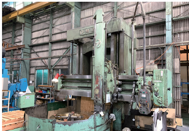
1973年に購入し、現在はJCP産機工場で大形遠心鋳造品(船尾管のシール部品)の加工を行うターニングマシン
